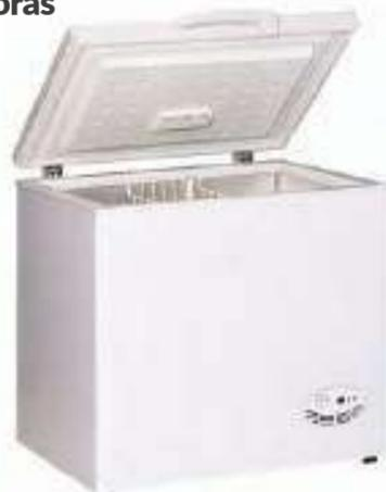
Temperatura de Funcionamento: -18°/-23°; Exterior em chapa plastificada; Cuba interior em alumínio; Isolamento em poliuretano injetado (72 mm); Condensação estática; Evaporação estática; Painel de comandos; Termóstato e sinalizadores; Tampa com chave; Luz no interior; Cap. 145 L; Dimensões: 64x85x60 cm
