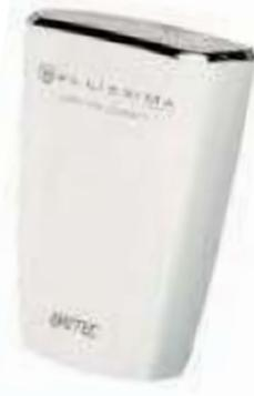
Tecnologia de Luz Pulsada; Até 300.000 Flashes; Flashes Automáticos: o dispositivo emite automaticamente pulsos de luz quando em contato com a pele, sem pressionar nenhum botão; Sensor de toque de pele; Sensor de movimento; 2 versões de usos; Sensor de cor de pele; 5 níveis de energia; Área de tratamento 3 cm<sup>2</sup>
